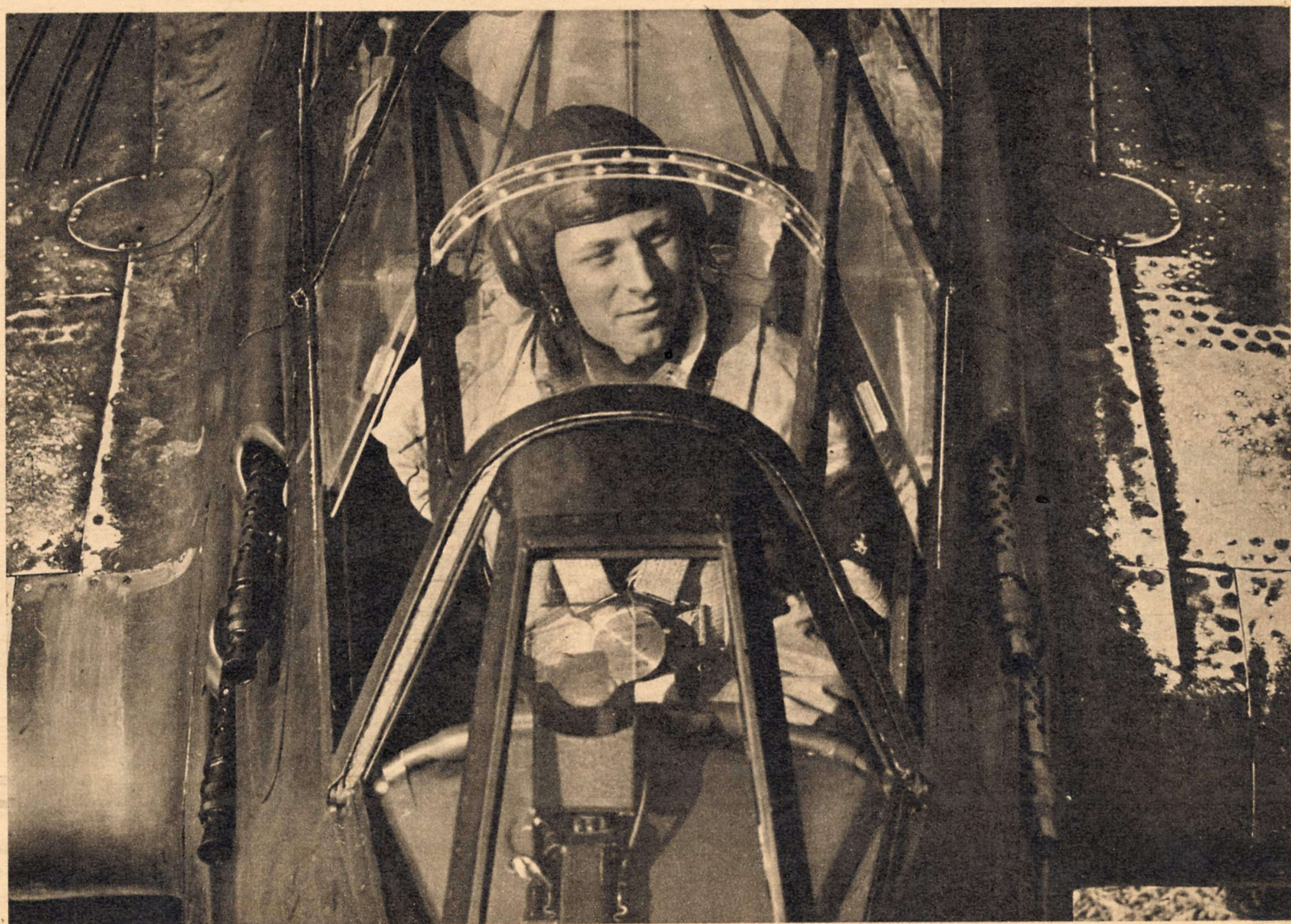
Zum Bilde rechts: Der Führersitz des neuen Zerstörers, neben dem die MGs zu beiden Seiten bis in die technischen Einzelheiten klar zu erkennen sind. Die Haube aus splitterfreien Glas gestattet dem Jagdflieger einen ungehinderten Blick nach allen Seiten
